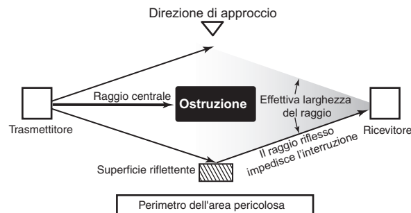
Figura 7: Esempio di interferenza della superficie riflettente
