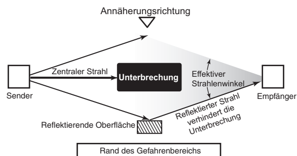
Abbildung 7: Beispiel einer Beeinflussung durch reflektierende Oberflächen
