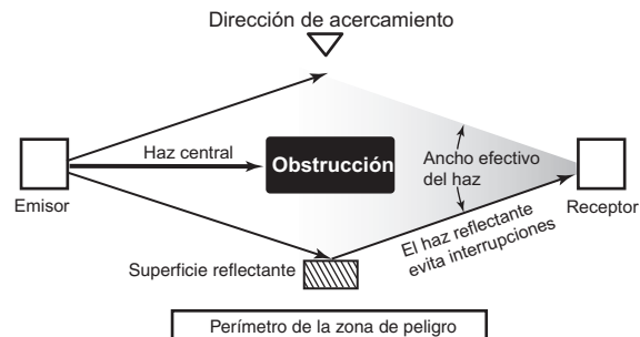
Ilustración 7: Ejemplos de interferencia causada por superficies reflectantes
